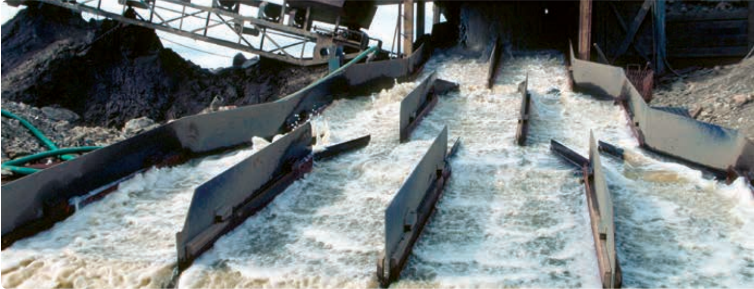
Sluice utilisé dans un site d'exploitation de placers de la région du Klondike
